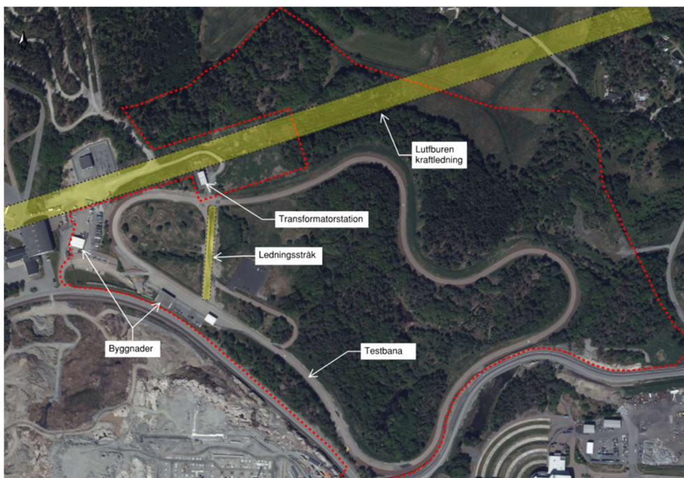
Figur 13 Översiktlig bild över undersökningsområdets befintliga konstruktioner.
